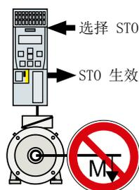
生效的 STO 功能会中断电机的供电。电机轴上无法再生成扭矩。
