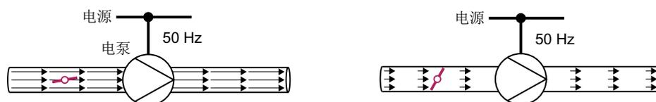
图 8-83 50 Hz 电源上使用泵和节流阀的流体控制
