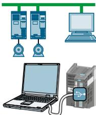
**STARTER** 和 **Startdrive** 是用于调试、诊断和控制变频器以及备份和传送变频器设置的 PC 工具。可通过 USB 或通过现场总线 PROFIBUS / PROFINET 将 PC 和变频器连接在一起。
