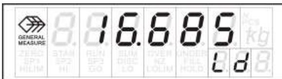
请记录本处的毫伏数及砝码的重量值，以备今后作为应急的无砝码标定。可在下表中填入作为备份：
