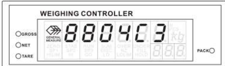
**停止状态：**初始上电仪表将进入这一状态，在此状态下，可进行系统标定，参数设定，自定义开关量及简单称重等，显示的内容可随意切换。仪表显示如下图所示。此时运行输出无效。
