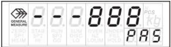
如果密码不正确仪表将返回密码输入状态，但显示由“-”变为“二”表示此为第二次输入密码。同样，准备第三次输入密码时仪表显示“三”。如右图所示。三次输入密码错误，仪表显示 **ERROR4** 并进入自锁状态，只有仪表重新上电方可再次进入工作参数设置。
