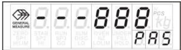
如果密码不正确仪表将返回密码输入状态，但显示“-”变为“二”表示此为第二次输入密码。同样，准备第三次输入密码时仪表显示“三”。如右图所示。三次输入密码错误，仪表显示 **ERROR4** 并进入自锁状态，此时即使输入正确密码也不会进入标定状态，只有仪表重新上电方可再次进入标定。
