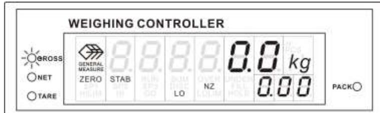
**运行状态：**通过仪表键盘、开关量或串口命令输入运行有效信号，仪表进入该状态。在此状态下仪表按预先设定的流量进行失重计量控制流量。当刚开始运行的时候，主显示自动切换为实时流量，副显示为输出的模拟量。运行后可以切换主显示的内容。仪表显示如下图所示。在此状态下运行输出有效。
