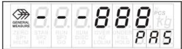
如果密码不正确仪表将返回密码输入状态，但显示由“-”变为“二”表示此为第二次输入密码。同样，准备第三次输入密码时仪表显示“三”。如右图所示。三次输入密码
