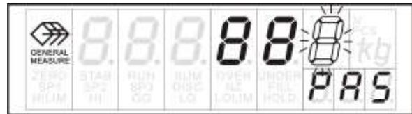
则不修改,主显示 **ERROR**,修改成功主显示 **PASS**。如不修改可直接按 键或 键,完成标定过程。
