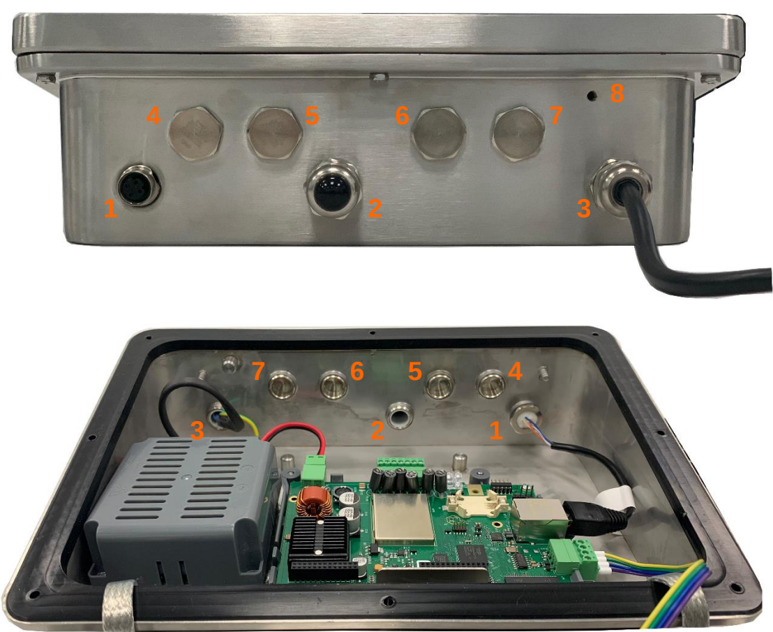
图 4-24: Harsh 防尘式外壳的电缆开口分配（内外视图）
