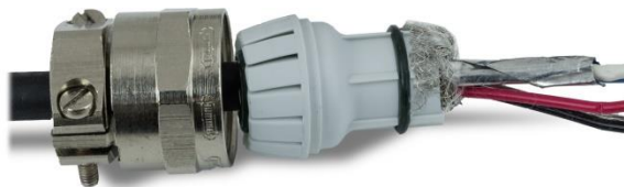
图 4-67: 内编织屏蔽层的各个电缆绞合线已解开并折回到护线圈上
