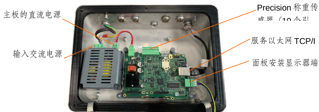
图 4-35: Harsh 防尘式外壳的 Precision 主板
