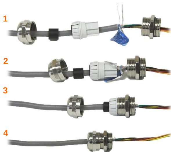
图 4-27：电缆屏蔽接地
