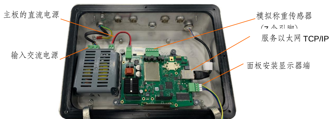
图 4-33: Harsh 防尘式外壳的模拟主板
