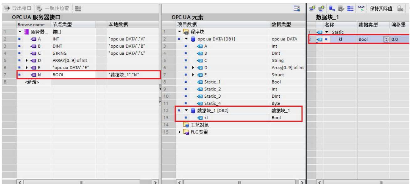
图10.非优化的DB块变量添加至服务器接口
