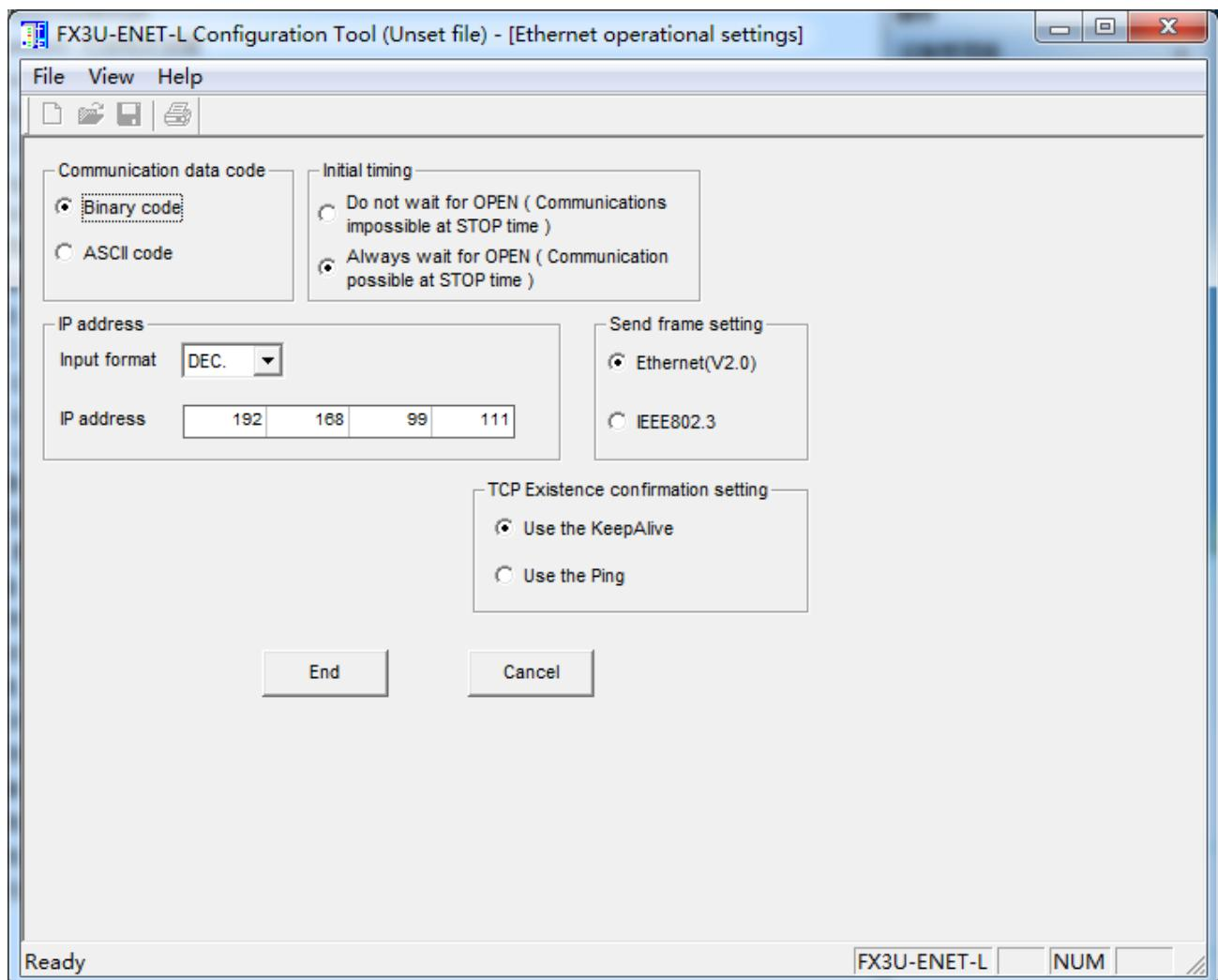
2.1 设置信息如图，IP地址根据产线不同设置不同的IP地址。设置完成点击End。
