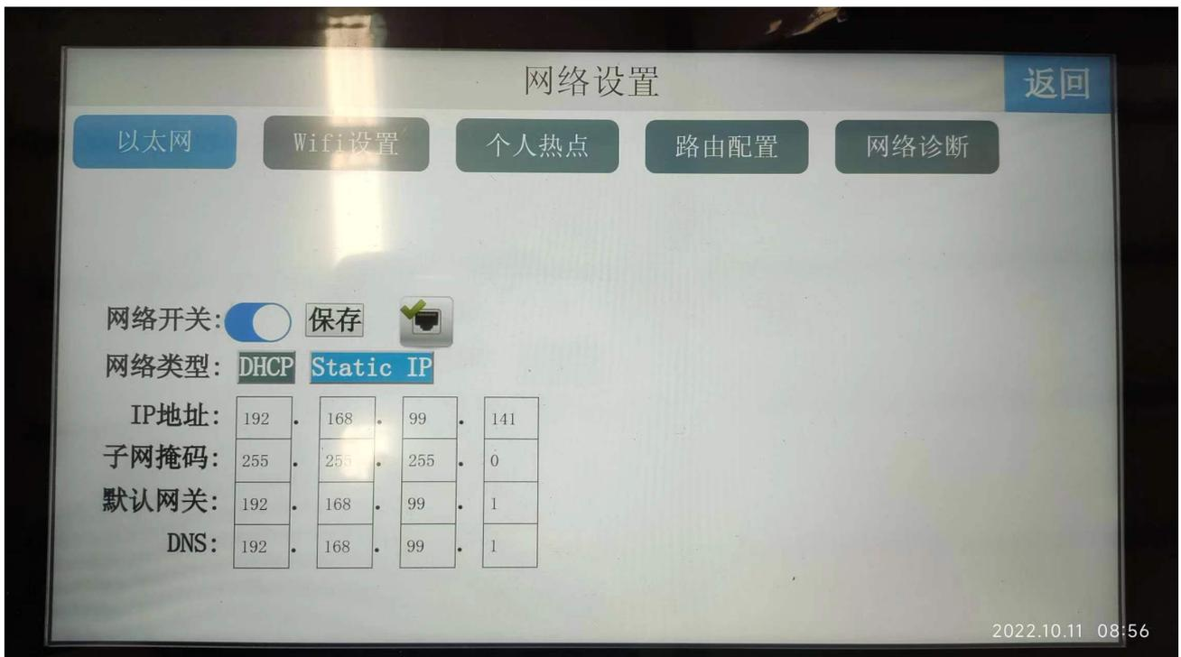
2.1以太网设置网络开关打开，网络类型选择Static IP。网地址设置如图。
